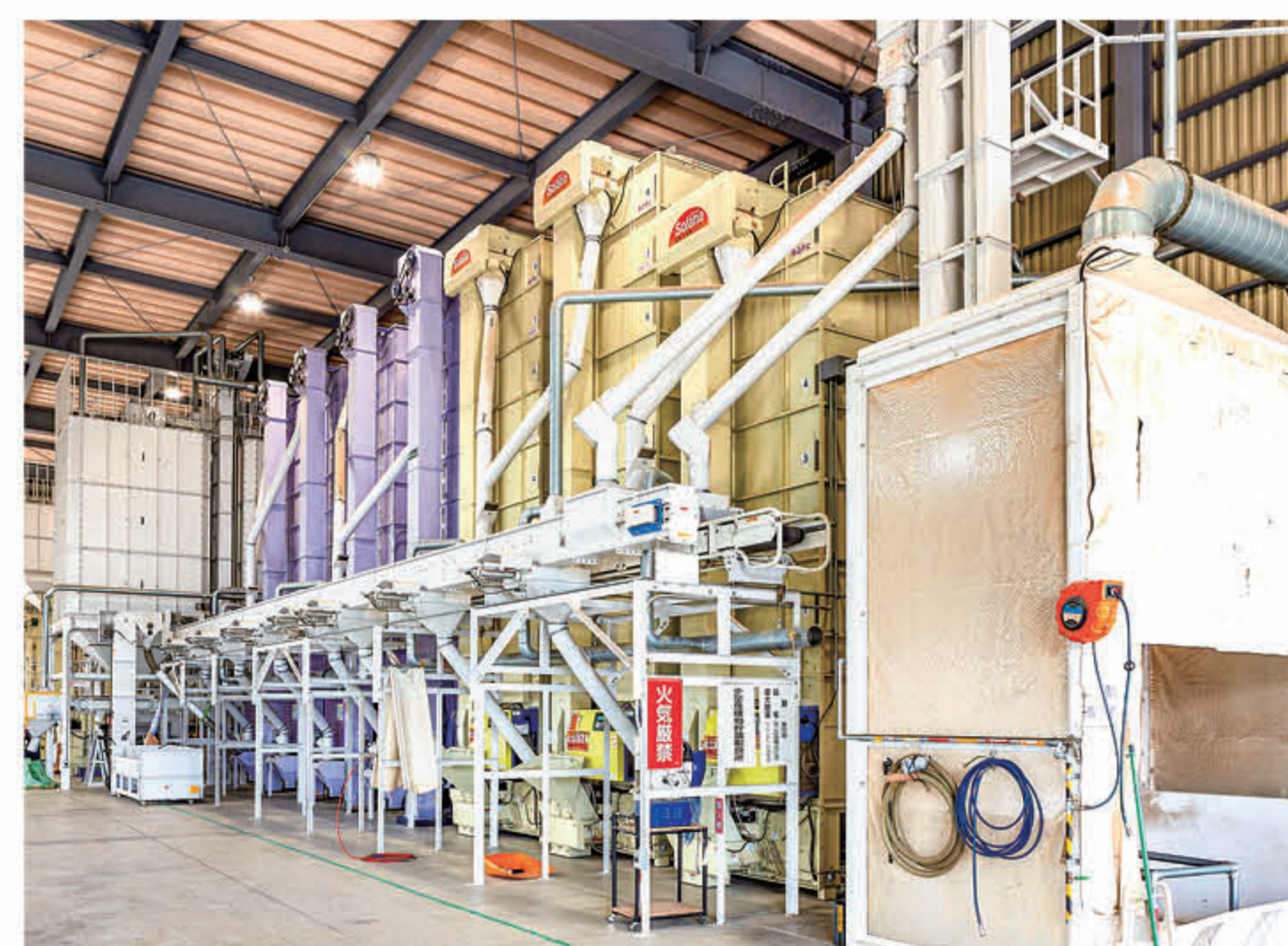
収穫した小麦はここに運ばれ、機械の中で風と熱を循環させて、まず乾燥させます。風を当ててゴミなどを飛ばしたら、メッシュに通して粒の大小を選別していきます。
