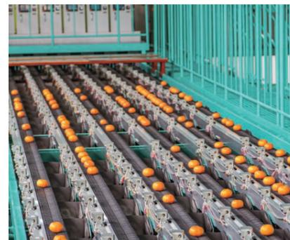
一つひとつ実の大きさや色、糖度などを機械がチェックし、センサーによって自動で仕分けしていきます。
