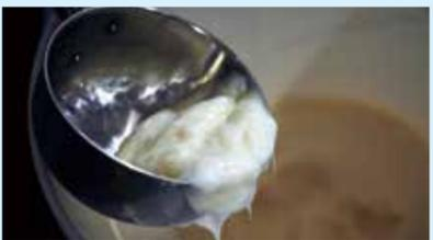
これがキシリットクール。ペースト状にして釜に入れ、糸の芯まで浸透させることで、冷感効果が長持ちします。キシリットクールは水分に反応するため、汗をかくとひんやり感じます。
