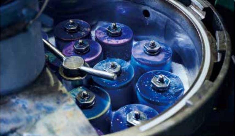
播磨染工(株)で行われる糸の染色工程。原糸を染色釜に入れ、染料を投入。濃色は全部で7時間ほどかけて染め上げます。
