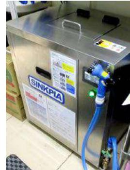
生物分解型生ごみ処理機（セブン-イレブン・ジャパン）
