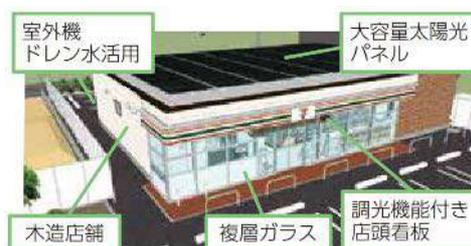
※店内設備では、LED配灯の見直し、ウォークイン内扉仕様の変更、店内の正圧化、チルドケースエアカーテン性能向上、冷蔵冷凍設備のオートクリーンフィルターなど、さまざまな省エネ設備を導入。
