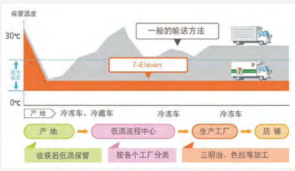
低温运输系统(低温物流网)的流程
