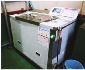
しました。この処理機は、生ごみを、水と炭酸ガスに分解して消滅させることで効果的に減量できます。2012年7月末時点で、2店舗に導入しています。
