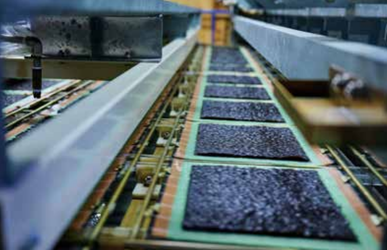
加工場に運ばれた海苔は、異物を除去してから真水で洗浄後、成型し、乾燥させます。
