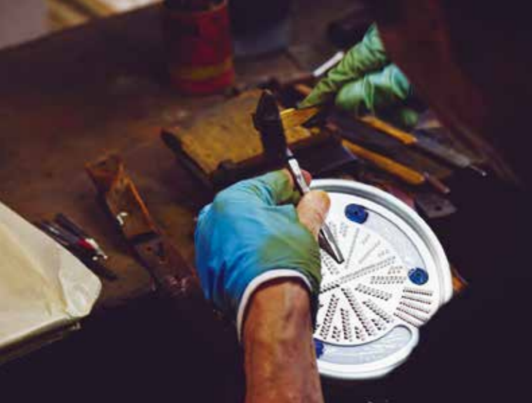
錫メッキを施した表面にたがねを当て、つちでトントン叩くと、中から銅本来の美しい色が出ます。
