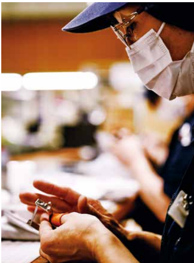
完成した「こだわりのステンレスピーラー」を指先で触り、ささくれがないか、刃の動きに異常がないかを一つひとつ丁寧に確認します。
