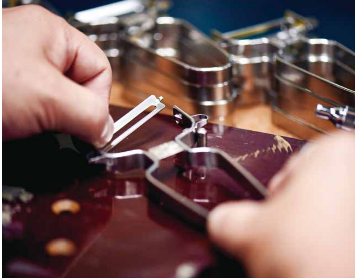
ピーラーの刃の組み付け作業。治具(ハンドルの部分)を広げて刃をつけ、しっかりと締めて固定します。
