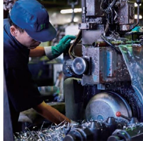
鑄型から取り出されたフライパンは旋盤にかけて、底面と側面を職人の熟練した技術で、重さが半分になるくらいまで両面を削ります。
