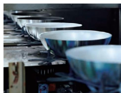
フライパンはベルトコンベアーで工場内をまわり、洗浄・塗装・焼成などを経て製品に仕上げます。
