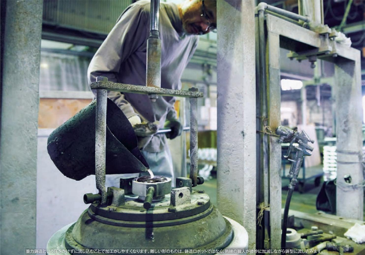
重力铸造という圧をかけずに流し込むことで加工がしやすくなります。難しい形の場合は、铸造ロボットではなく、熟練の職人が微妙に加減しながら鑄型に流し込みます。
