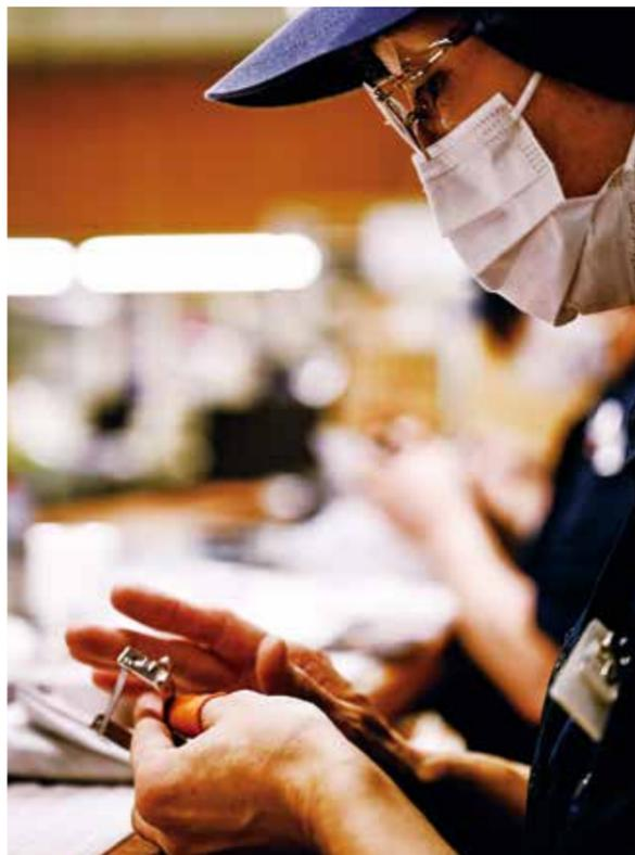
完成した「こだわりのステンレスピーラー」を指先で触り、ささくれないか、刃の動きに異常がないかを一つひとつ丁寧に確認します。
