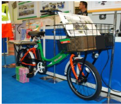
ノーパンクタイヤを搭載した 電動自転車
