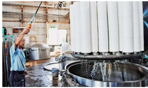
原糸を細長いボビンに巻きとり、それを大きな釜に入れて精練・漂白します。こうしてコットンの色素を落とし、糸をつくる時のロウや鉱物油などを取り除いています。精練・漂白が終わった糸は、元の糸より白さが際立っていました。
