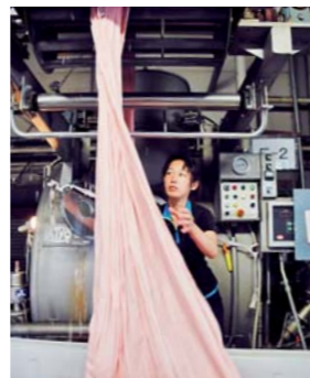
染色槽にタオル生地を入れて、ゆっくりと回転させて染める液流染色。4~5時間かけて染めたタオル地を取り出します。
