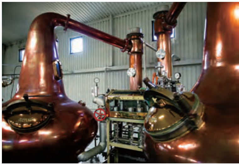
単式蒸溜器(ポットスチル)はスコットランド製で、くびれがないストレート型。デザイン自体は、この蒸溜所オリジナルの形です。
