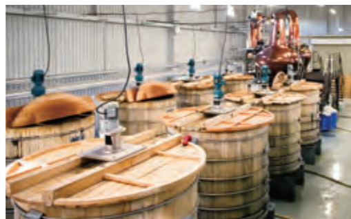
大麦の粉碎から糖化、発酵、蒸溜、ビン詰めまで、すべて一カ所で行われています。手前がミズナラの発酵槽。
