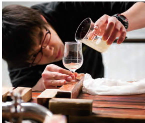
粉碎した麦芽にお湯を加えてタンクに仕込むと、麦汁の糖化が始まります。粉碎した麦芽がフィルターとなって麦汁がろ過されていきます。スタッフが麦汁の透明度を見ながら、ろ過の状態をチェックしていました。
