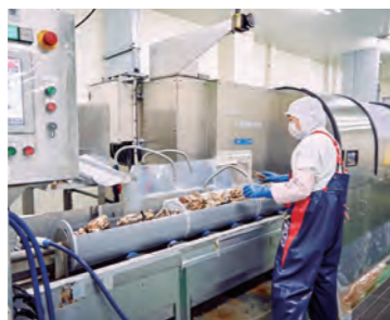
高圧をかけて牡蠣をむく超高压機も導入されています。これには、牡蠣の滅菌効果やノロウイルスが不活性化する効果も期待されています。
