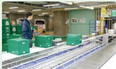
コンテナに入った商品はベルトコンベアに乗り、配送地域別の流れてきます。
