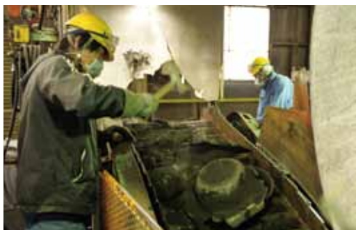
1時間ほどたつと、鉄器は砂まみれの状態で出てきます。木槌を使って砂を落とし、さらに機械の振動を使って落としていきます。
