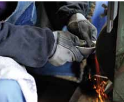
へりをグラインダーで削って仕上げる、熟練の技がいる作業です。
