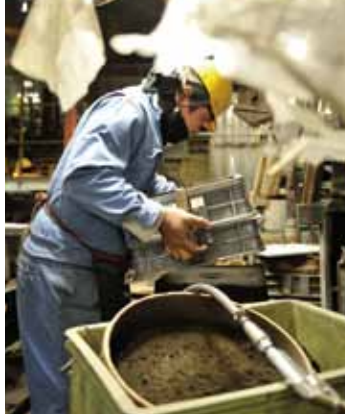
鑄物砂を鑄型に詰め、上からプレスして鑄型を作る工程。
