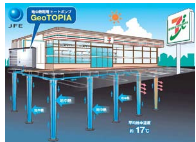
冬は外気より暖かく、夏は冷たい「地中熱」を利用することで、空調の電力削減につながります。
