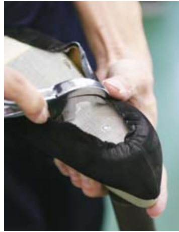
上・左／「Made in JAPAN」のパンプスの生産現場。18の工程を約25人のスタッフで担当。木型に甲皮を“吊り込む”作業はベテラン職人の手作業。(マルボロコーポレーション)
