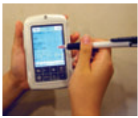
見やすい画面をタッチすることで、ボタン式の押しミスがなくなったオーダー用の新ハンディターミナル。ここで入力された情報が、無線LANによって各ディスプレイに送られます。
