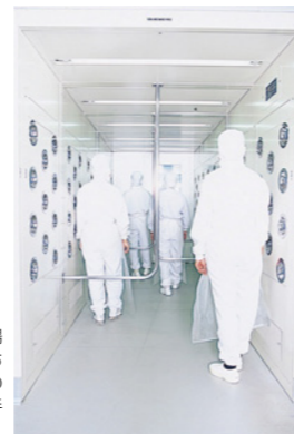
専用工場では、製造現場にほこりや髪の毛を持ち込まないよう、入室前のエアシャワーや入念な手洗いを徹底
