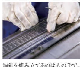
編針を組み立てるのは人の手で。ホールガーメントは、編針を並べた針床を4枚使用します。
