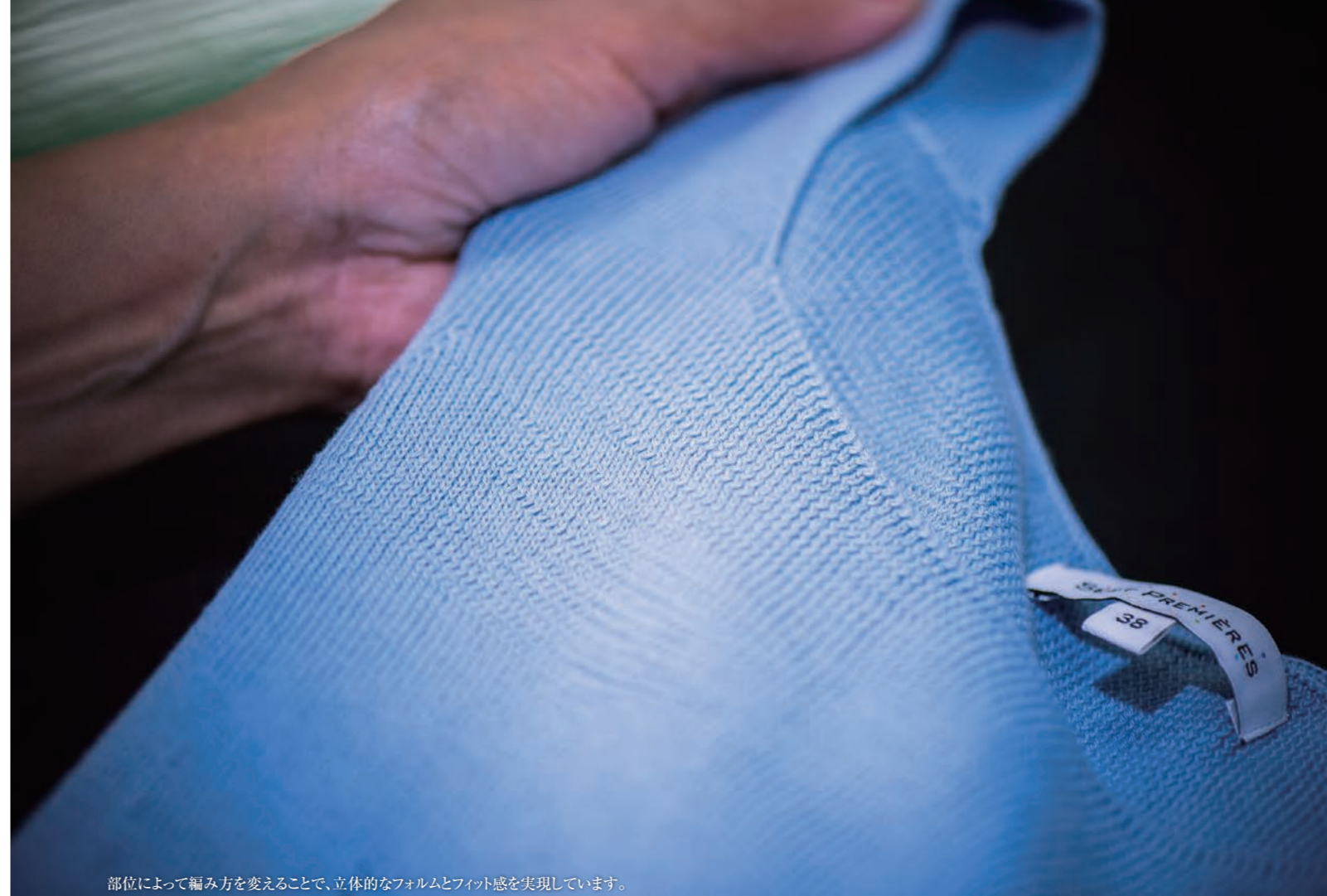
部位によって編み方を変えることで、立体的なフォルムとフィット感を実現しています。
