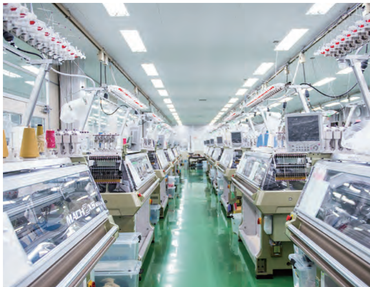
糸への影響を考え、機械が置かれた部屋は湿度を60%に保っています。機械は24時間稼働できます。
