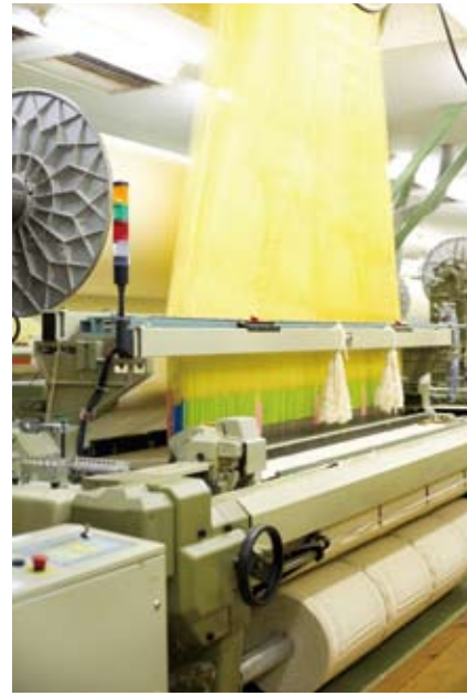
大きなタオル地が次々に織り上がっていきます。織機はイタリア製。機械はコンピューターで制御され、広い工場内で働くのは14人ほど。
