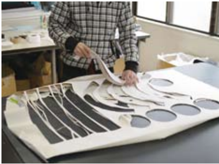
芯を接着した布を幾枚も重ね、コンピュータで効率的な布どりをを行ったうえで、カッターマシンで各パーツを抜いていきます。
