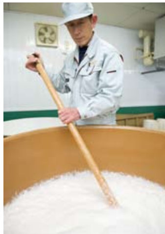
もろみの発酵を促す酵母を培養しての酒母(もと)づくり。酒母屋と呼ばれる職人には、長年の経験と勤が求められます。
